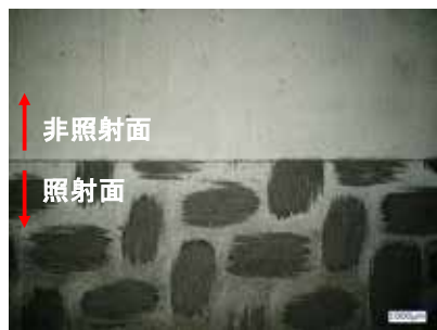
図2. キセノンアーク灯式促進耐候試験後（180 W/m 2 , 200 h）のCFRP表面
