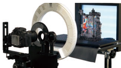
「Polamazing®1000」ガラスなど透明・半透明材料の歪みや異方性の数値化ができる。共同開発企業：日本ビジュアルサイエンス株式会社
