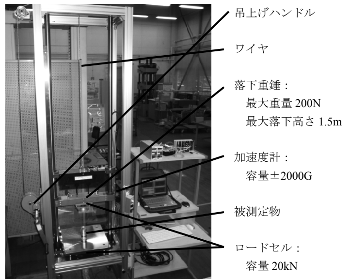
図1. 落錘式衝撃特性評価試験機概要
