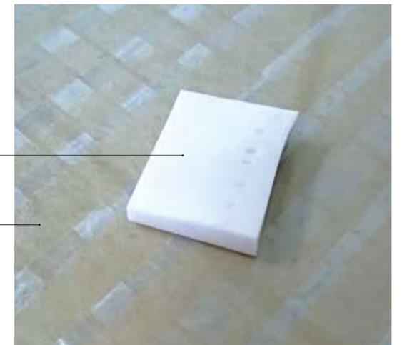
図2 PVCマットに接触させた市販のPVC消しゴム
