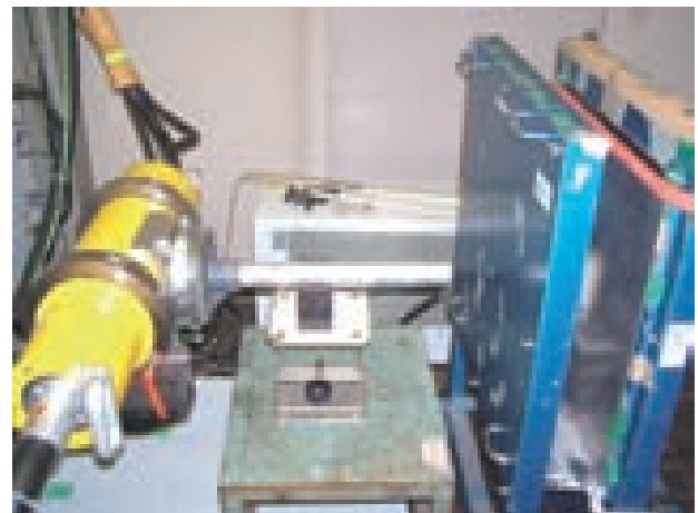
図2. 試作多段凹面レンズ (レンズ長500mm中に82個の凹面を配列。凹面曲率は5mm、凹面間隔は1mm)
