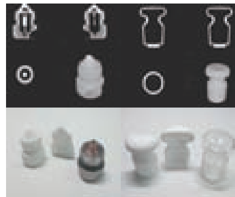
図5. 部品のCT像とRP造形品
