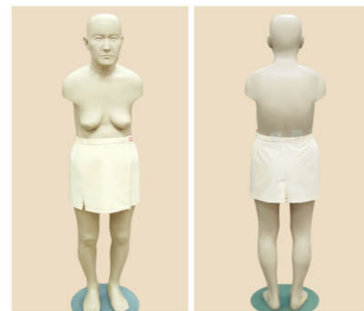
衝撃吸収パッドの位置の検討などに使用した「高齢者ボディ」。日本人の 70 代女性の平均的な体型を再現している。
