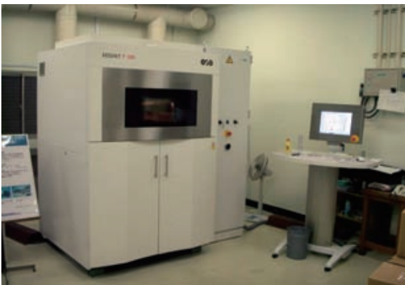
図1. ナイロン粉末焼結型RP装置 (EOSINT P385)
