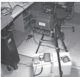
図 5. 太陽電池の I-V 特性測定
