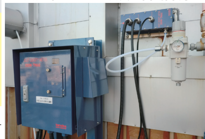
白煙中のダスト濃度を自動計測
