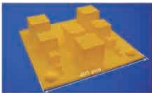
図1. 吹付ガン式植毛装置による植毛品
