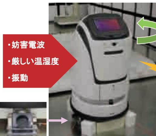
車輪速度センサ 自律移動案内ロボットの供試装置
