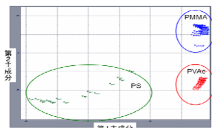
図5. PCA解析に最適と考えられたモデル 正規化処理によって全体のスペクトル強度を同等にするとともに、ベースライン変動やスペクトルノイズを低減させる処理を経ている
