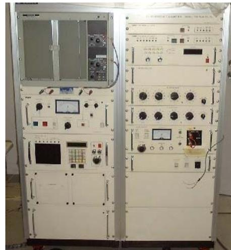
図 1. 直流磁化特性測定装置
