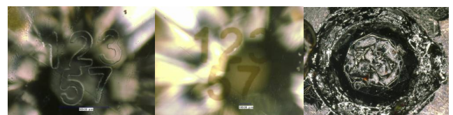
(a)照射前 (b)照射量： レジストを塗布し、 1 \times 10^{14} ions/cm 2 現像した後 レジスト除去後 (c)照射量： 5 \times 10^{14} ions/cm 2 レジストが炭化
