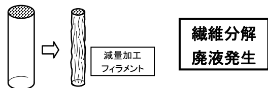
図1. ポリエステル繊維のアルカリ減量加工 (上図) 生地の減量化 (下図) フィラメントの減量化
