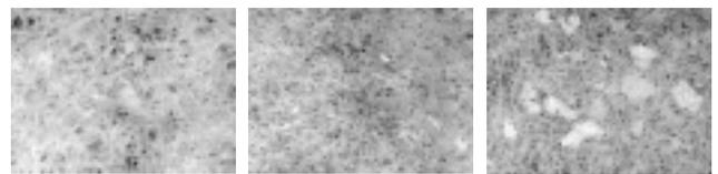
図3. 回収パルプ繊維による試作紙
