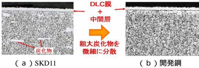
図2 基材の金属組織
