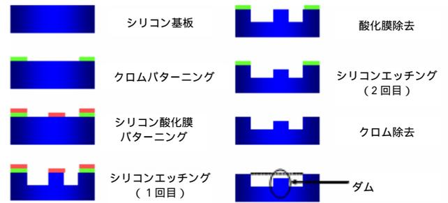
図3. シリコン型の製作工程
