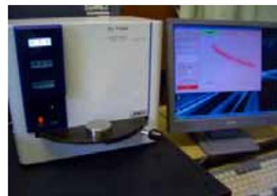
図1. 照射食品検知用 PSL 測定装置
