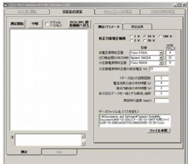
図6 電圧分圧器の分圧比の校正画面
