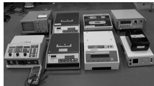
図2. 使用した電気メス及び電気メステスタの一部
