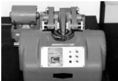
写真1 テーパー形摩耗試験機
