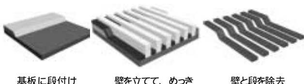
図1 壁を立てて小さな板バネ部品を作る
