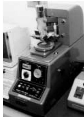
写真2 カスタム形摩耗試験機
