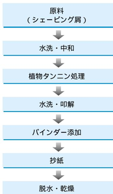
図1 レザーボード製造工程の概略
