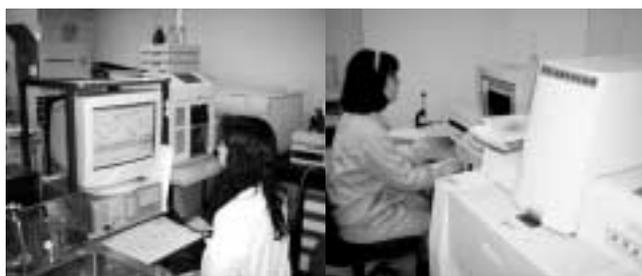
写真1 めっき液の分析（左）膜厚さ測定（右）
