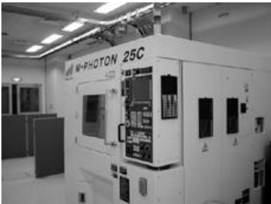
写真1 金属光造形複合加工システム
