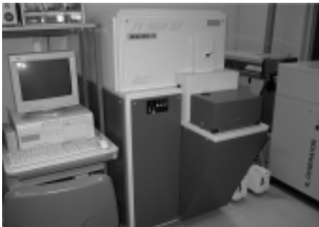
図1 グロー放電発光分光分析装置 (ジョバン・イボン社製 JY5000RF、マークス型)
