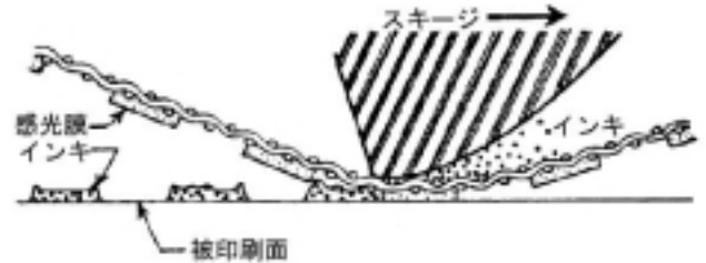
図1 スクリーン印刷の原理
