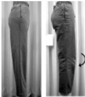
新品 14ヶ月着用用品 写真1 ズボンの形状 着用前後でズボンの膝部分が突出することがわかります。
