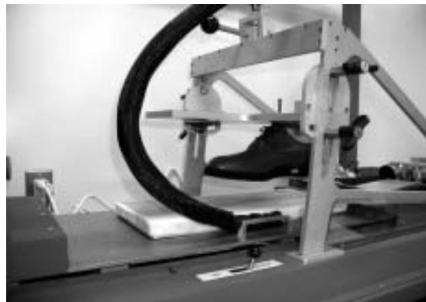
写真2 耐滑性試験機の概観
