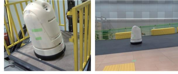
車輪配置と重心の幾何学関係に基づく設計により、ロボットの転倒に対するリスクを低減し、静的安定性試験装置や傾斜路走行試験装置を用いて、評価を行いました。
