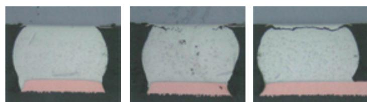
正常な状態      クラック発生      完全破断
