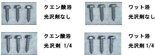
図3 バレル法で得られためっき試料の外観写真
