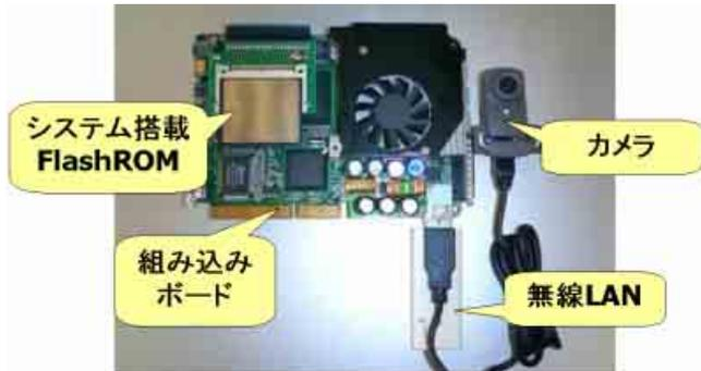
図2 アプリケーション搭載試作ボード
