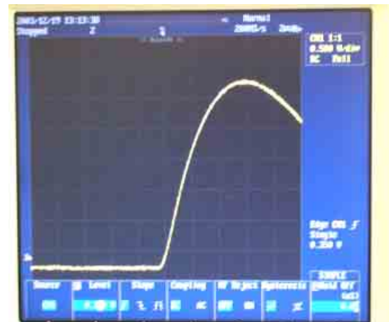
図 4 長時間熱起電力の安定度特性および高温暴露結果
