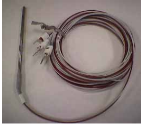
図3 試作に使用した白金測温抵抗体
