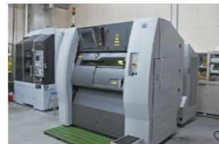
金属粉末造形装置 最大造形：W250×D250×H300 mm 造形品材料：ステンレス鋼 17-4PH レーザー種類：ファイバーレーザー
