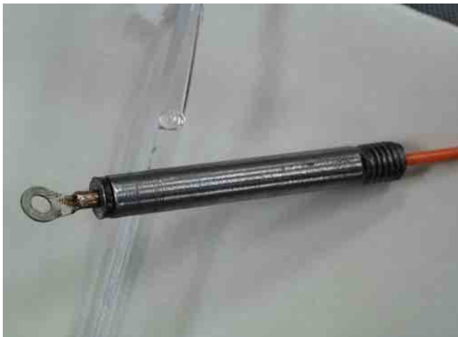
図5 ジグに組み込んだ引張用ロードセル
