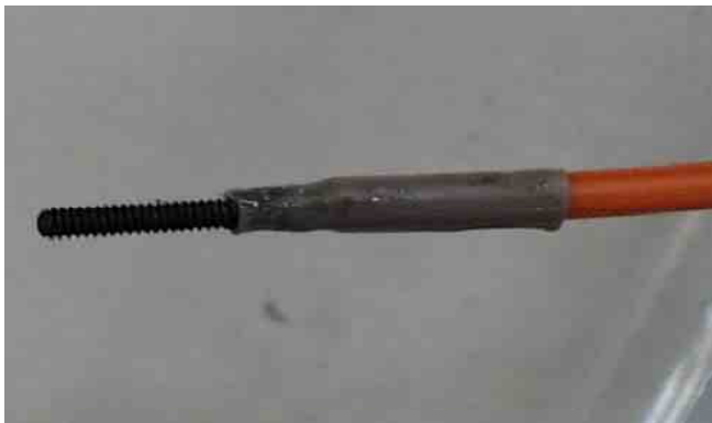
図4 M3止めねじ引張用ロードセル
