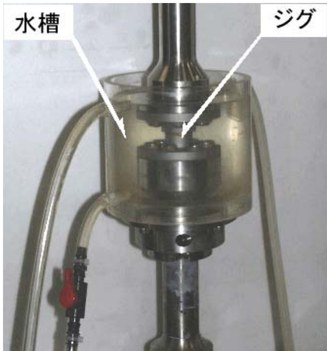
図2 腐食環境下での疲労試験方法
