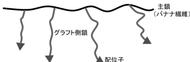
図 1. 新規バイオマス系金属イオン捕集材
