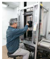
自動強伸度試験機 (5 kN)
