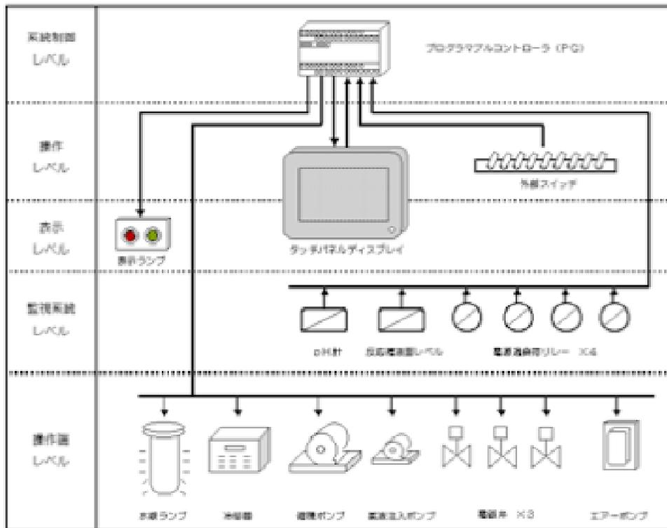
図2 排水処理装置における運用管理システムの構成
