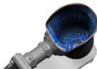
図1. 測定データによるリバースエンジニアリング
