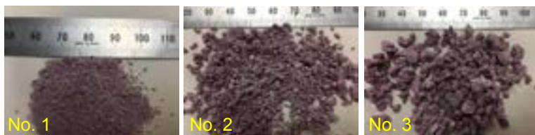
転動造粒法により造粒した1wt% Au/Al 2 O 3 触媒
