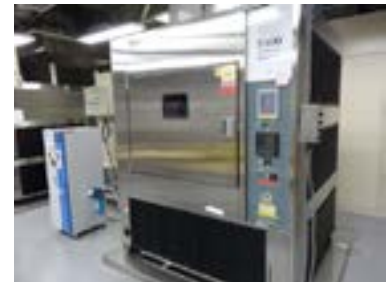
図1. 促進耐候性試験機（サンシャインウェザーメーター）の外観
