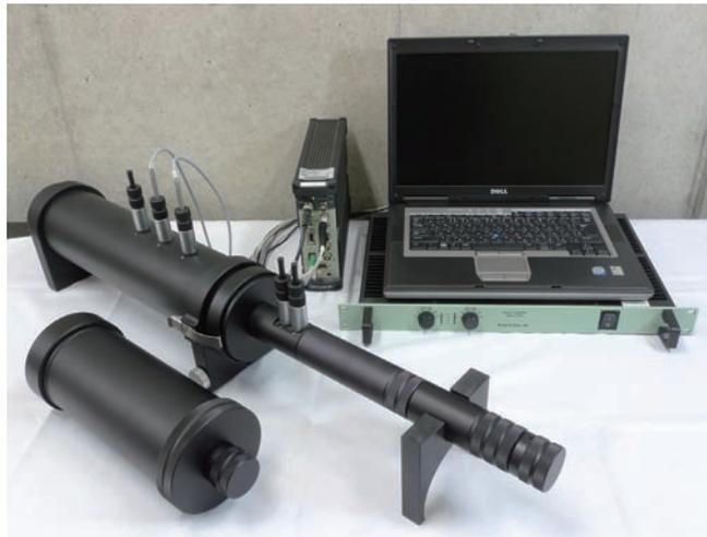
音響管(垂直入射吸音率・音響透過損失測定装置)
