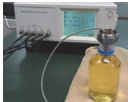
図2. 静電容量計測（都産技研試作加工室）
