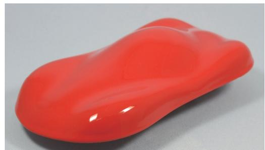
図 1. RP 立体モデルへの塗装完成品
