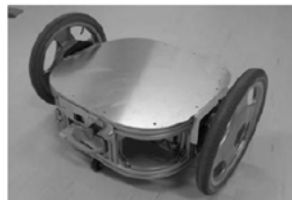
図1. 非ホロミック系車両(左)と制御目的(右)
