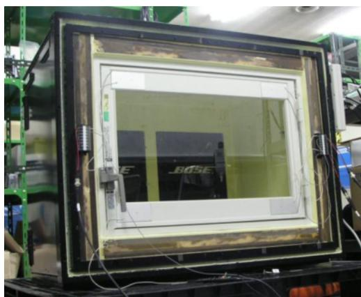
図 1 アクティブ遮音硝子とエンクロージャ
