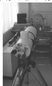
図2 当所で使用している赤外放射計による測定例
