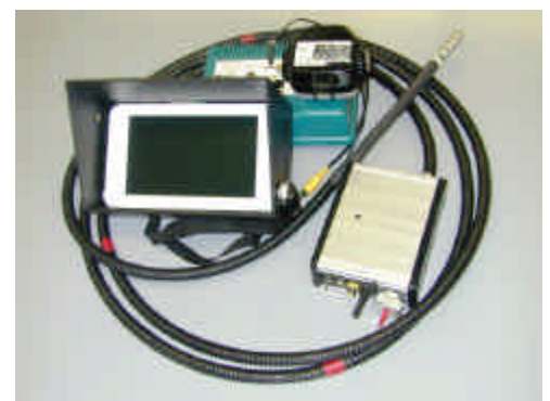
図 4 開発したマンホール用カメラ
