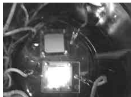
図2 外径10nmのCNTを含有する複合膜から放出された電子による励起した発光
