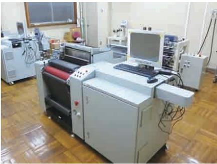
炭素繊維強化プラスチック製造機 (CFRP試織機)
