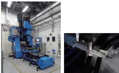
写真 2D-FSW装置 (2次元摩擦攪拌接合装置) (左) と接合中の外観 (右)。
