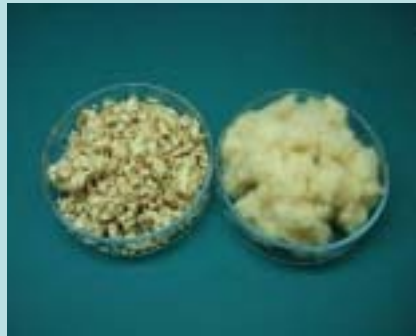
ミキサーと金網で柔細胞を分離除去して得た純粋な竹繊維(左:パルプ状、右:ワタ状)
