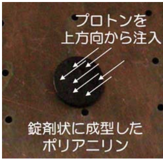
図4 ペレット状ポリアニリンへのプロトン注入
