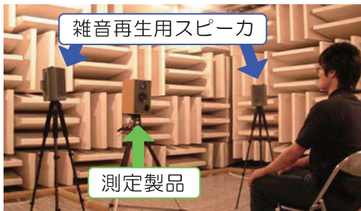
図1 都産技研 無響室での 語音弁別能試験の様子
