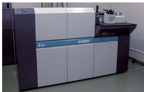
図1 二重収束型高分解能ICP質量分析装置 試料中の微量元素の定量をワンランク上の高感度(ppb、ppt)でおこなうことができます
